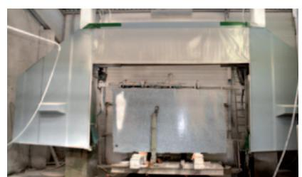
L'atelier est équipé également de trois monofils et d'un bi-fil Chauvet pour le sciage primaire des blocs, de deux polissoirs à plats T500 Thibaut, d'un fil Contour Bidesimpianti, de débiteuses numériques TC750 et TC 600 Thibaut, d'un polissoir à chant pour semelles Omega de Comandulli, etc.
