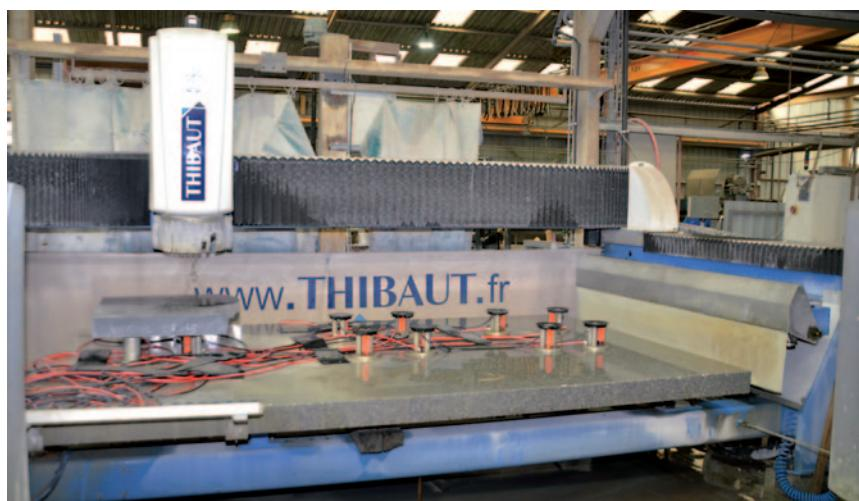
Le centre d'usinage numérique T812 Thibaut est plus particulièrement utilisé pour l'usinage de pièces de formes complexes pour notamment les monuments funéraires et cinéraires de la gamme Acanterra et de la nouvelle collection des Ateliers de Montredon.
