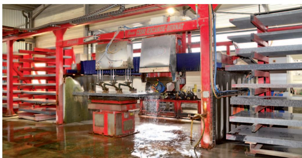
*ductivité puisqu'elle se déplace sur un long chemin de roulement permettant de placer plusieurs pierres. Elle offre un gain de manutention puisque les stèles, baguettes, socles, etc., sont totalement usinés et polis sans avoir à gérer leur manutention. Nous pouvons aussi traiter tous types d'usinage spécifiques avec le T958, et notamment les pièces les plus complexes et techniques comme celles que l'on retrouve sur les monuments de la gamme Acanterra, explique Bruno Carivenc, le directeur.*
